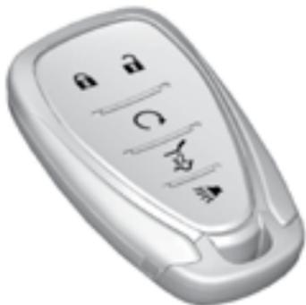
Показан пульт дистанционного управления автомобиля с системой дистанционного запуска двигателя и электроприводом двери багажного отделения
