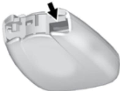
1. Нажмите кнопку в нижней части корпуса пульта дистанционного управления и извлеките ключ. Не допускается извлекать механический ключ, не нажимая кнопку.
