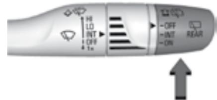
Переключатель очистителя заднего стекла находится на конце рычага выбора режимов очистителя ветрового стекла.
