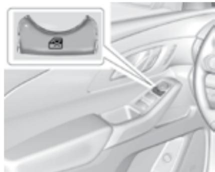
Данная функция позволяет блокировать индивидуальные переключатели электропривода стеклоподъемников задних дверей и управлять ими только с помощью переключателей, расположенных на двери водителя.
