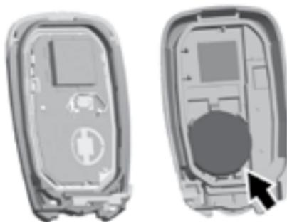
3. Извлеките элемент питания, прижав его и сдвинув к нижней части корпуса пульта.
