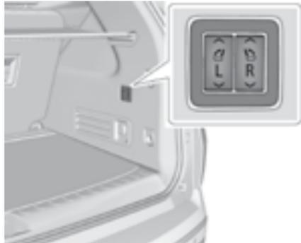
При соответствующей комплектации спинки сидений третьего ряда можно складывать и возвращать в вертикальное положение, нажав и удерживая переключатели, расположенные на боковой облицовочной панели багажного отделения со стороны пассажира.
