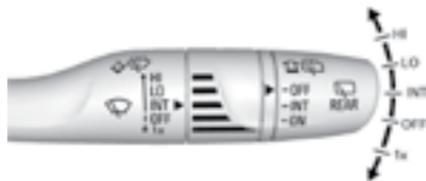
При включенном зажигании или режиме ACC/ACCESSORY кнопки запуска двигателя переместите рычаг выбора режимов очистителя ветрового стекла, чтобы выбрать частоту движения щеток стеклоочистителя.
