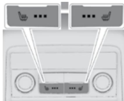
При соответствующей комплектации кнопки переключателей располагаются на панели управления в торцевой части центральной консоли.
