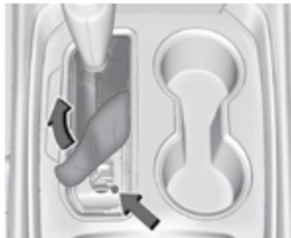
2. Снимите пылезащитный чехол рычага селектора, потянув вверх заднюю часть декоративной накладки.
