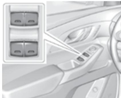
Питание к электроприводам стеклоподъемников подается при включенном зажигании, в режиме ACC/ACCESSORY кнопки запуска, а также в режиме задержки отключения питания дополнительного оборудования (RAP). См. *Режим задержки отключения питания дополнительного электрооборудования (RAP)* → 187.
