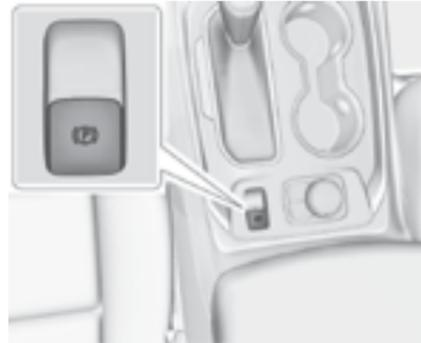
Данный автомобиль оснащен стояночным тормозом с электроприводом (EPB). Стояночный тормоз с электроприводом может быть задействован всегда, даже при выключенном зажигании. Во избежание разрядки аккумуляторной батареи не пользуйтесь стояночным тормозом с электроприводом при выключенном двигателе слишком часто.
