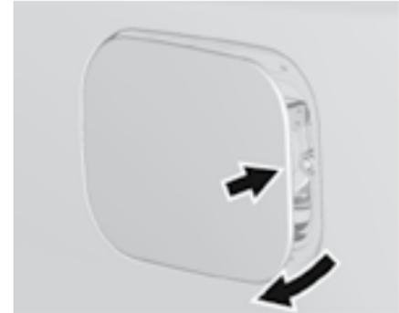
Чтобы открыть лючок горловины заливного отверстия, нажмите на край крышки лючка со стороны задней части автомобиля и отпустите.
