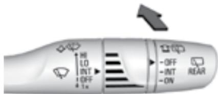
При соответствующей комплектации нажмите рычаг переключателя режимов очистителя ветрового стекла вперед, чтобы подать жидкость омывателя на объектив камеры зеркала заднего вида. После того, как рычаг будет отпущен, он возвращается в исходное положение. См. *Внутреннее зеркало заднего вида с функцией вывода изображения с камеры* → 32.
