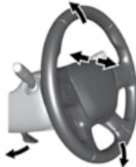
Для регулировки положения рулевого колеса:
