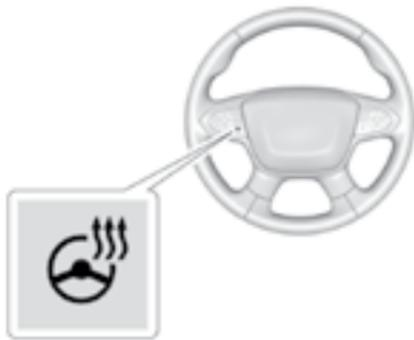
**☞ (обогрев рулевого колеса):** при соответствующей комплектации нажмите для включения/выключения функции обогрева. Индикатор рядом с кнопкой выключателя обогрева горит, когда обогрев включен.
