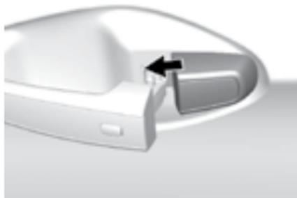
3. Сдвиньте крышку вперед и прижмите ее передний край, чтобы зафиксировать.
