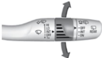
**INT (прерывистый режим):** переместите рычаг выбора режимов очистителя ветрового стекла в положение INT. Поверните кольцевой регулятор вверх для выбора более коротких интервалов или вниз – для более длинных интервалов.
