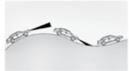
Не используйте систему ACC при движении по холмистой местности или при буксировке прицепа. При движении по холмистой местности система ACC не будет обнаруживать автомобили, движущиеся впереди вашего автомобиля. При движении по холмистой местности чаще, чем при движении по равнинной, приходится ускоряться и тормозить, особенно при буксировке прицепа. При нажатии педали тормоза система адаптивного круиз-контроля отключается.
