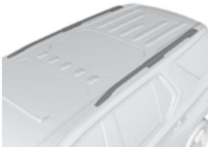
Для предотвращения потери или повреждения груза во время движения проверьте крепление поперечин на рейлингах и самого груза. При перевозке груза на багажнике на крыше смещается центр тяжести
