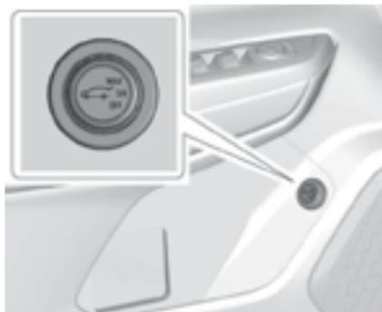
На автомобилях, оборудованных электроприводом открывания/закрывания двери багажного отделения, переключатель управления приводом расположен на двери водителя. Рычаг селектора должен находиться в положении P (парковка).
