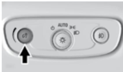
Яркость дисплея комбинации приборов, дисплея и подсветки органов управления информационно-развлекательной системы, подсветки кнопок на рулевом колесе и других органов управления, а также индикаторов состояния функций можно отрегулировать.
