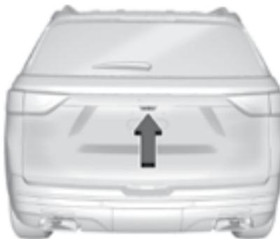
Камера, изображение с которой выводится на дисплей внутреннего зеркала заднего вида (RCM), расположена над площадкой государственного номерного знака рядом с камерой заднего обзора (RVC).
