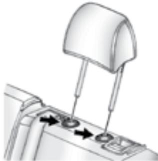
2. Одновременно нажмите обе кнопки, фиксирующие стойки подголовника, потяните подголовник вверх и снимите его.
