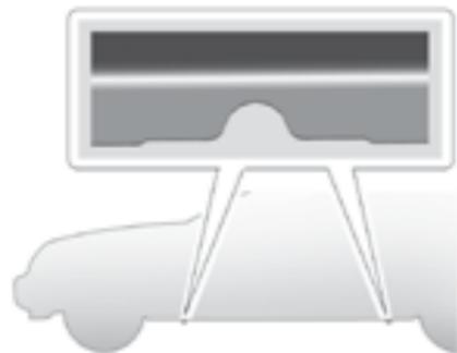
4. Установите верхнюю опору домкрата в специально предназначенное для этого место в непосредственной близости от поврежденного колеса.
