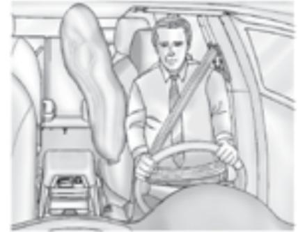
Модуль передней центральной подушки безопасности расположен на внутренней боковой части спинки сиденья водителя.
