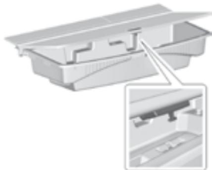
3. Надежно зафиксируйте панель пола багажного отделения.
