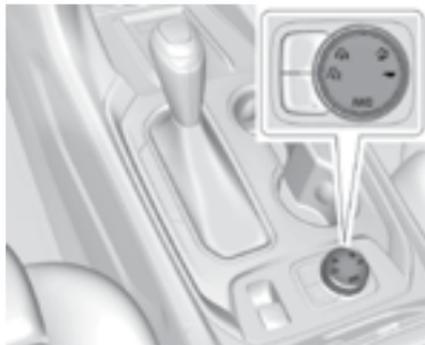
Для выбора режима полного привода поверните рукоятку переключателя в положение **4x4**.
