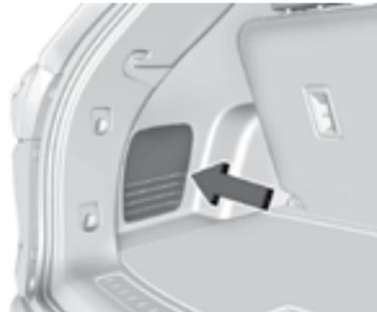
Блок предохранителей, расположенный в багажном отделении, находится за боковой панелью облицовки багажного отделения со стороны водителя.
