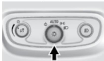
Переключатель наружных световых приборов расположен на приборной панели слева от рулевой колонки.
