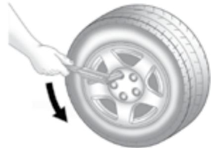
2. Поворачивая колесный ключ против часовой стрелки, ослабьте все колесные гайки, но пока не снимайте их.
