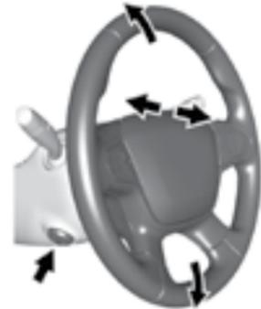
При соответствующей комплектации переключатель привода регулировки положения рулевого колеса находится на левой стороне рулевой колонки.
