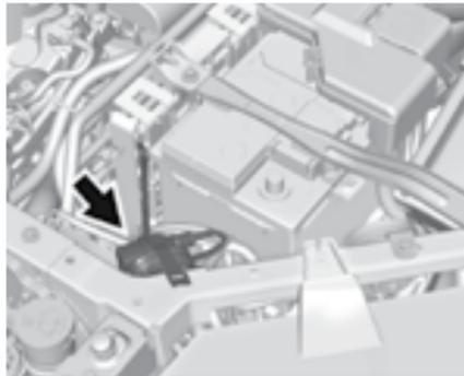
2. Откройте капот и размотайте электрический кабель предпускового подогревателя. Смотанный кабель находится в моторном отсеке со стороны водителя перед аккумуляторной батареей. См. *Моторный отсек* → 242.
