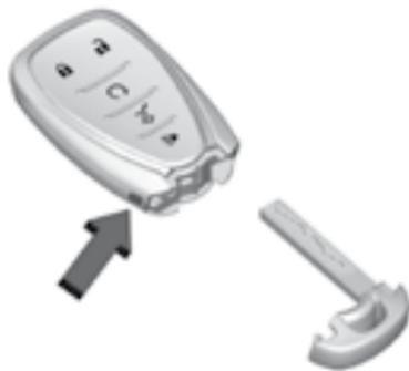
Чтобы извлечь ключ, нажмите кнопку, расположенную в нижней части корпуса пульта дистанционного управления, и выньте ключ. Не допускается извлекать механический ключ, не нажимая кнопку.
