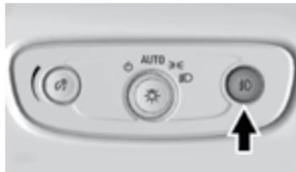
Кнопка выключателя противотуманных фар находится на приборной панели сбоку от рулевого колеса.
