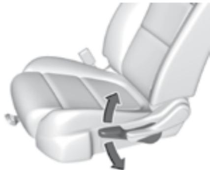
При соответствующей комплектации перемещайте рычаг вверх или вниз, чтобы поднять или опустить сиденье.
