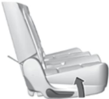
1. Откиньтесь на спинку сиденья и потяните рычаг регулировки наклона спинки.
