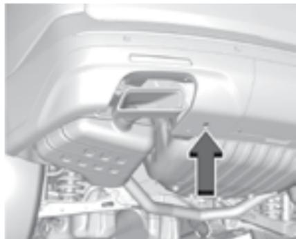
Очистите линзу в углублении мягкой тканью, смоченной водой.
