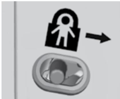
При соответствующей комплектации выключатели блокировки задних дверей находятся на внутренних краях задних дверей. Для использования выключателя блокировки замка:
