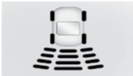
На дисплее систем помощи при парковке на комбинации приборов (при соответствующей комплектации) отображаются блоки, показывающие расстояние до объекта, а также информация системы помощи при парковке задним ходом, касающаяся расположения препятствий. По мере приближения к препятствию количество подсвеченных блоков увеличивается и цвет блоков изменяется с желтого на оранжевый и красный.
