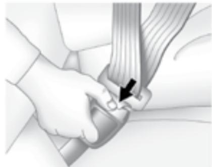
Чтобы отстегнуть ремень безопасности, нажмите кнопку разблокировки, расположенную на замке ремня безопасности. Ремень должен вернуться в исходное положение.
