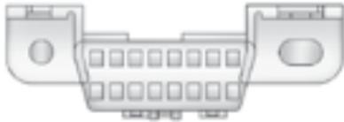
Диагностический разъем расположен под приборной панелью слева от рулевого колеса. Подсоединение к этому разъему диагностических приборов, не предназначенных для проверки системы управления токсичностью отработанных газов или технического обслуживания автомобиля, может повлиять на работу автомобиля. См. *Дополнительное электрооборудование* → 235. При необходимости обратитесь в авторизованный сервисный центр.
