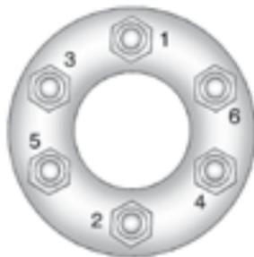
14. Надежно затяните колесные гайки в диагональной последовательности, как указано на рисунке.
