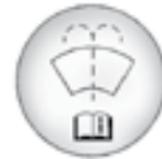
Откройте крышку с данным символом. Долейте жидкость омывателя стекол так, чтобы заполнить весь бачок. Расположение бачка см. в *Моторный отсек* → 242.
