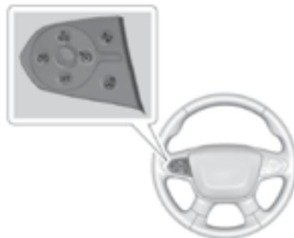
**Ⓢ (вкл./выкл.):** нажмите для включения или выключения системы. Когда система ACC включена, индикатор на комбинации приборов загорается белым цветом.
