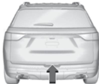
Для открывания двери багажного отделения коснитесь сенсорной панели, расположенной на внутренней стороне ручки двери багажного отделения, и поднимите дверь вручную.
