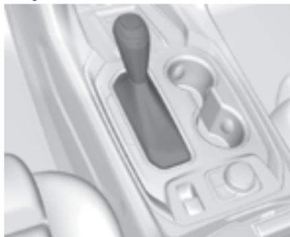
**Р (парковка).** В данном положении ведущие колеса автомобиля заблокированы. При запуске двигателя рычаг селектора должен находиться в этом положении, чтобы автомобиль не мог начать самопроизвольное движение.
