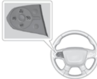
**Ⓢ (вкл./выкл.):** нажмите для включения/выключения системы круиз-контроля. При включении системы на комбинации приборов загорается индикатор белого цвета.
