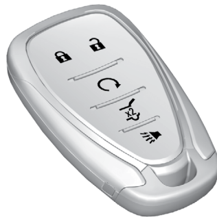
Показан пульт ДУ автомобиля с электроприводом двери багажного отделения
