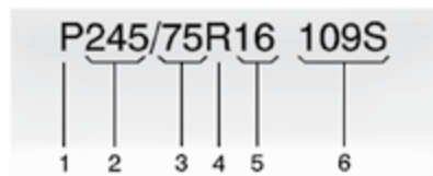
Пример маркировки шин для легкового автомобиля (P-Metric)
