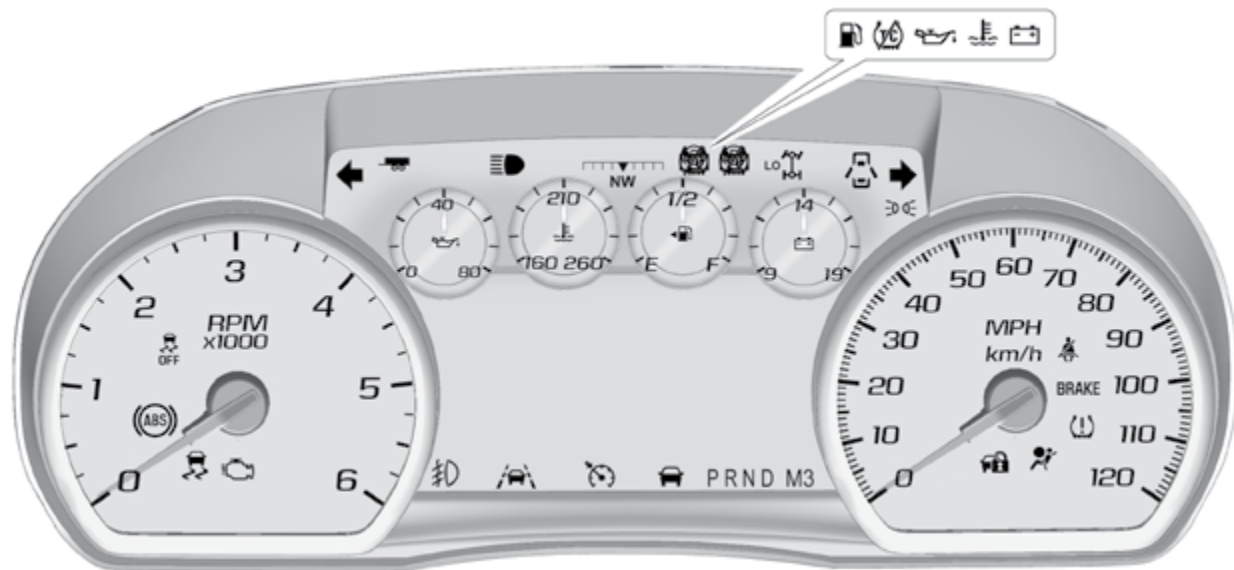
Показана комбинация приборов с британской системой единиц измерения (топовая комплектация); комбинация приборов с метрической системой – аналогично
