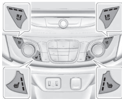
Показаны кнопки автомобиля с сиденьями с функциями обогрева и вентиляции; кнопки автомобиля с сиденьями с функцией обогрева – аналогично
